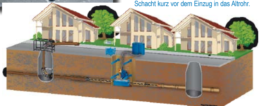
Durch den Verformungsprozess werden eine höhere Kurvengängigkeit und leichtere Handhabung erreicht. Die Materialstrukturen bleiben dabei erhalten. Eine Überdehnung des Grundmaterials wird ausgeschlossen. Das Foto oben zeigt den Rückverformungsprozess im Schacht kurz vor dem Einzug in das Altrohr.
