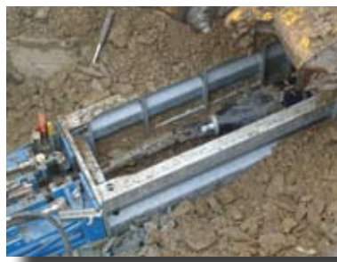
Kurzgestänge kann an das normale QuickLock-Gestänge angebunden werden und ist ebenfalls schub- und zugstabil.
